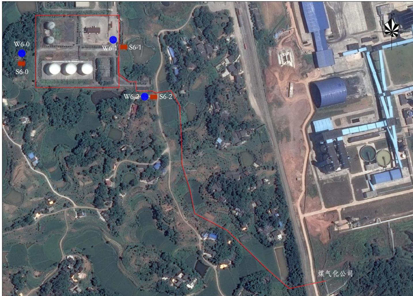
附图 6 企业土壤及地下水自行监测布点图（绿源醇火车站库区）
