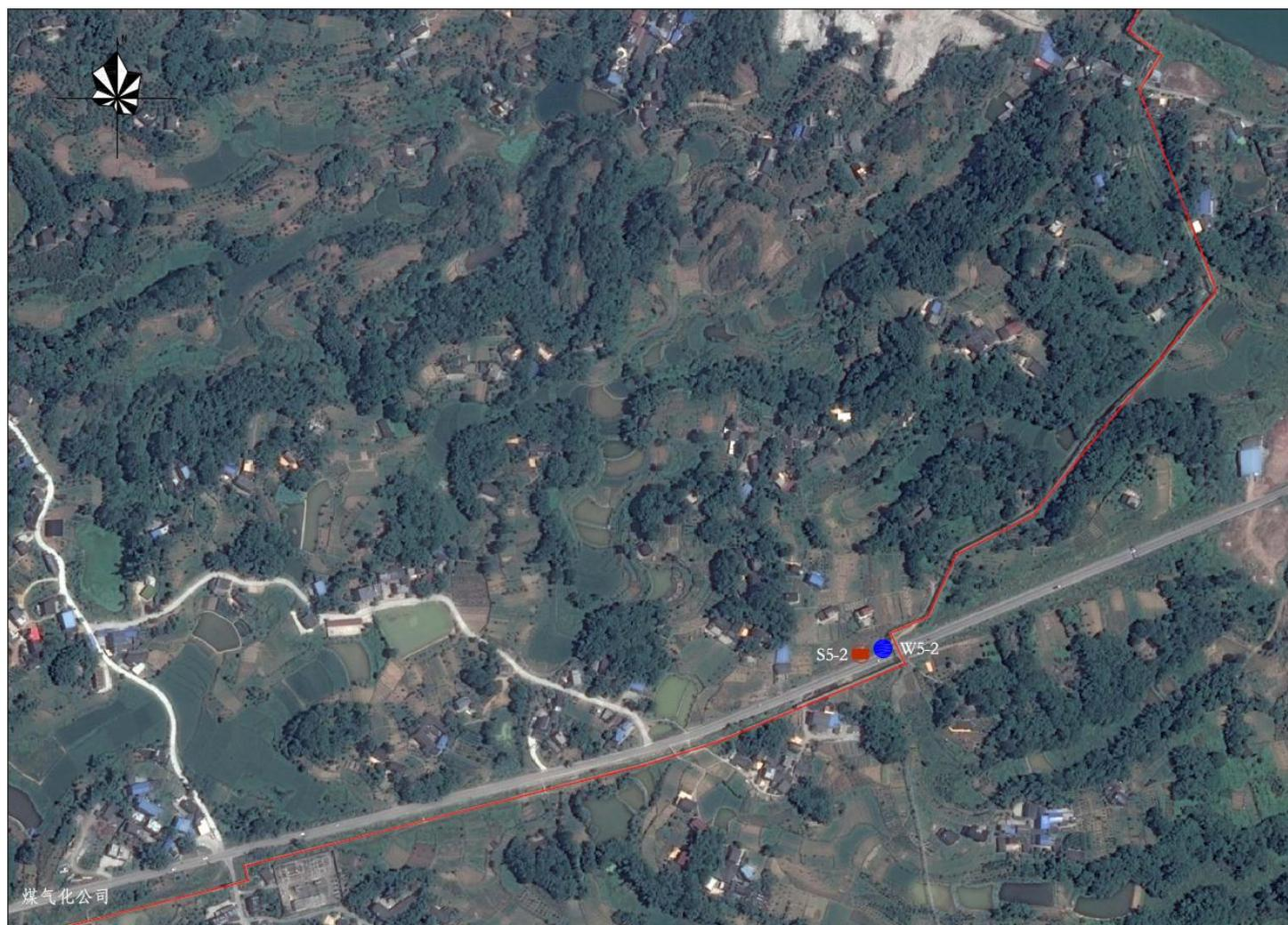
附图 5-2 企业土壤及地下水自行监测布点图（火车站库区输送管廊）
